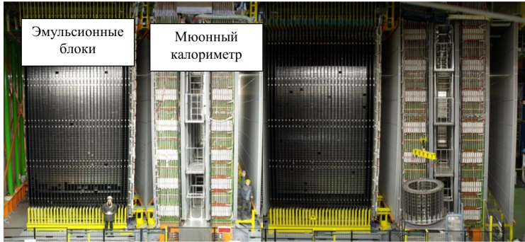
Рис. 1: Фотография детекторной системы эксперимента OPERA
