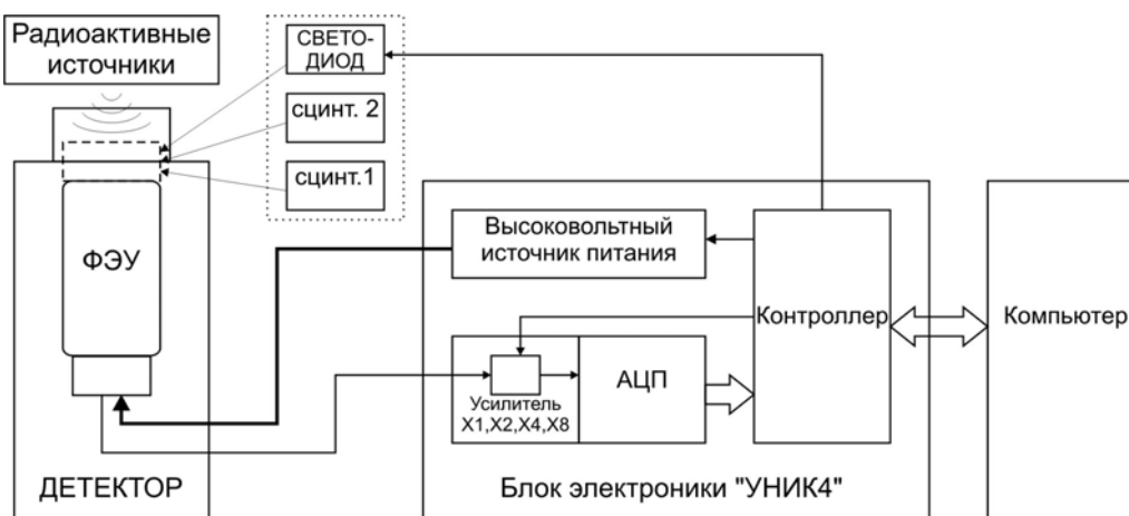
Рис. 12. Блок-схема сцинтилляционного спектрометра.
